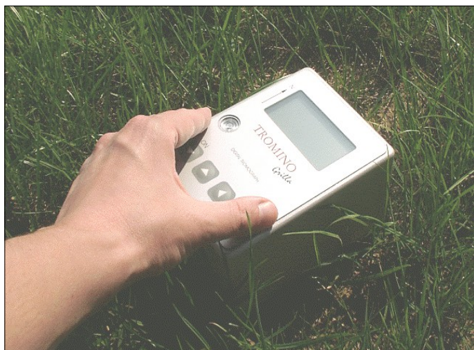
Illustrazione 1 Posizionamento del tromografo sul terreno. L'accoppiamento strumento - terreno è garantito dall'infissione di particolari "piedini".
