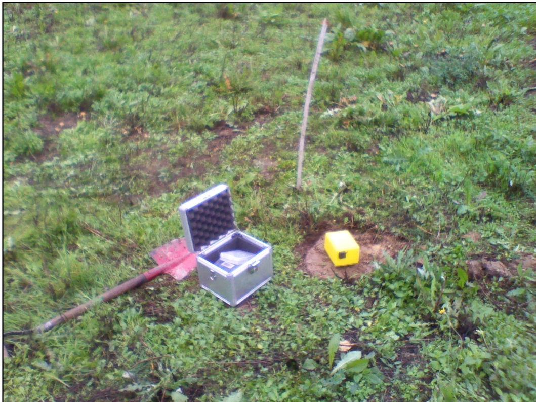
Foto n.2: Prova di simica passiva a stazione singola
