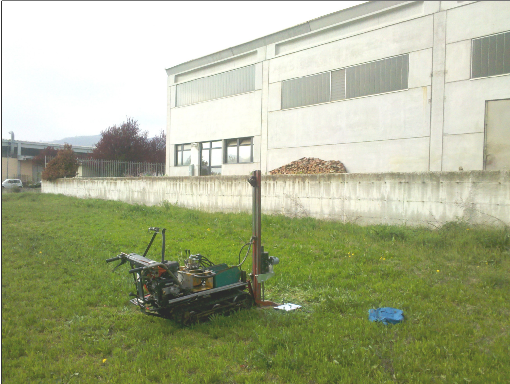
Foto n.1: Prova penetrometrica dinamica n.1
