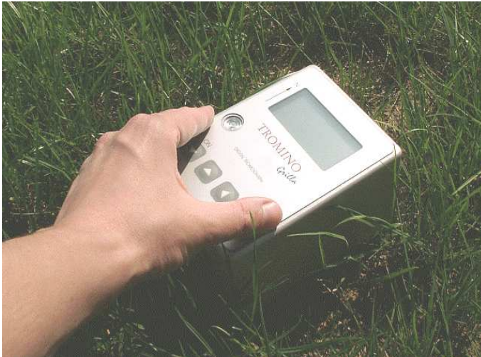
Illustrazione 2: Posizionamento del tromografo sul terreno. L'accoppiamento strumento - terreno è garantito dall'infissione di particolari "piedini".
