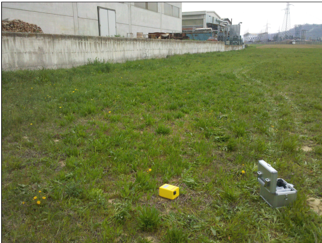
Foto n.2: Prova sismica passiva a stazione singola
